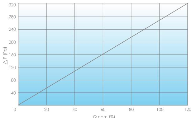
Bu sistemde boyutlar ve basınç düşümü minimize edilerek yüksek hacimdeki havanın arıtılması sağlanmaktadır.
